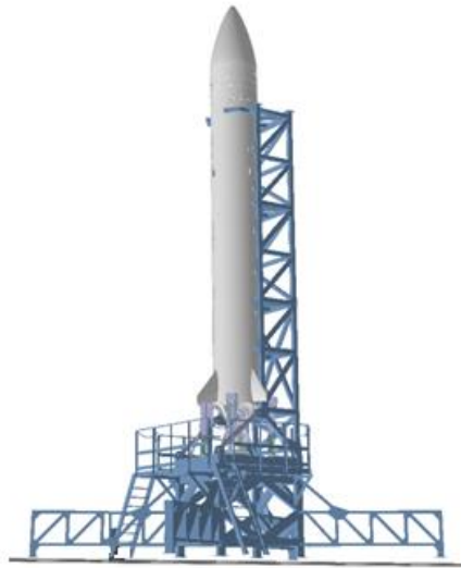
Figura 19 - Diseño Estructura soporte - torre izaje
