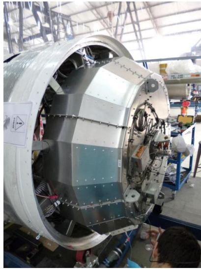
Figura 10- Integración módulo de control
