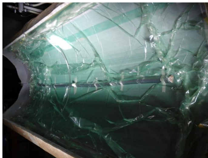
Figura 11 – Construcción fuselaje compuestos
